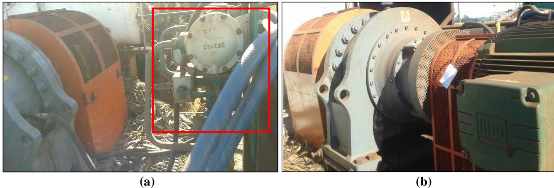
FIGURA 1 – Redutores planetário Marca SEW-EURODRIVE modelo P30 utilizados para comparações, sendo que (a) possui unidade de arrefecimento e filtragem (destacado); Redutor sem unidades de tratamento do óleo (b);
